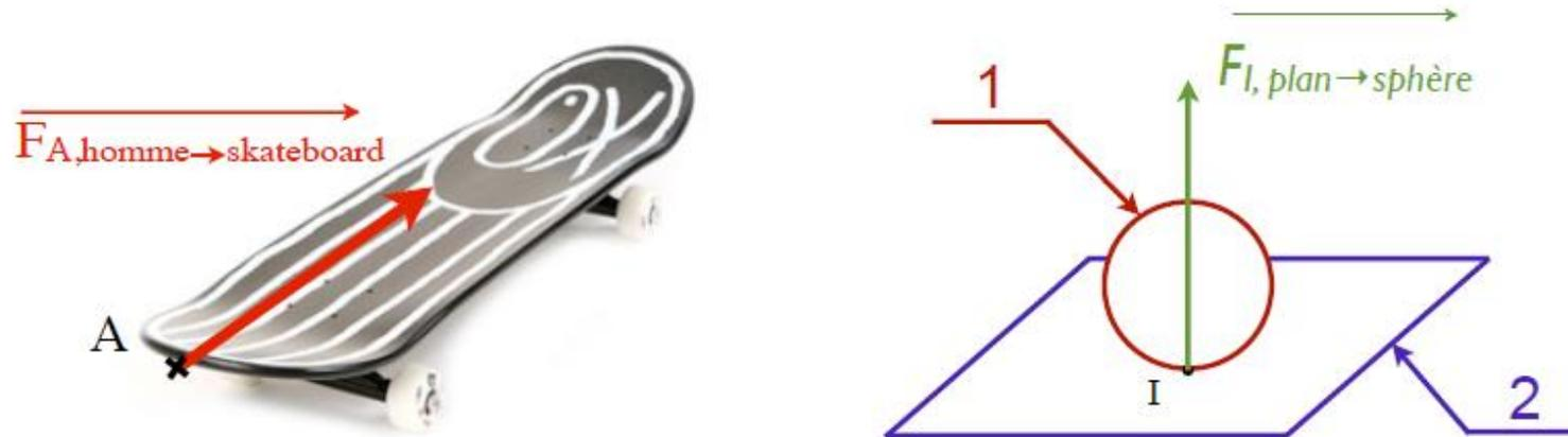
Action mécanique  $\rightarrow$  graphiquement  $\rightarrow$  flèche dont l'origine est placée en un point.
